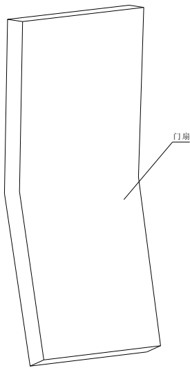
图11 门扇高度方向弯曲度示意图
